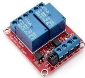
Рисунок 25. 2-канальный модуль реле
